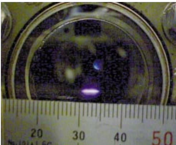
図6 CVD装置に取り付けられたサファイアに放射光を照射した際の発光の様子（写真中央の横長輝線）
