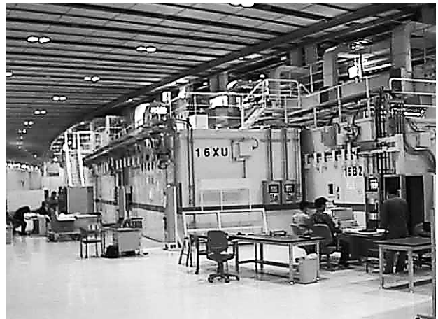
図1 実験ハッチ外観 (右手がBL16B2で、左手のBL16XUと一体構造になっている。)
