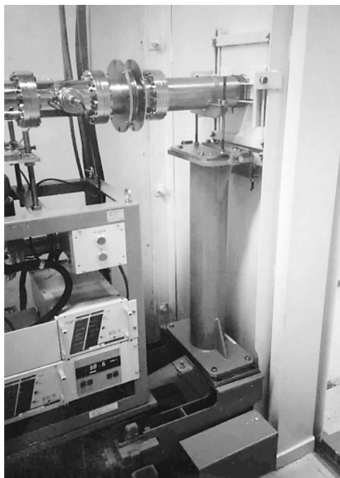
図2 傾斜架台(左)と光学ハッチと実験ハッチをつなぐ可動型ビームパス
