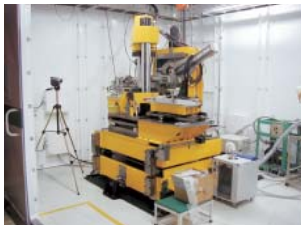
Fig. 7 マルチアンビル型高温高圧発生装置SMAP180
