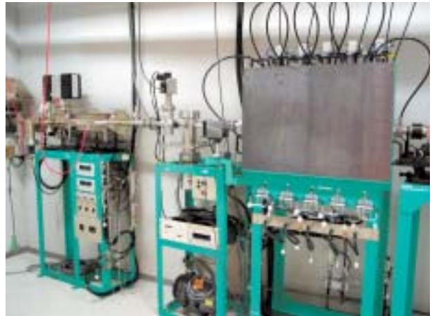
Fig. 4 光学ハッチ内上流部の設置状況 左から差動排気装置、真空排気ユニット、局所遮蔽体を付けた五連フィルター
