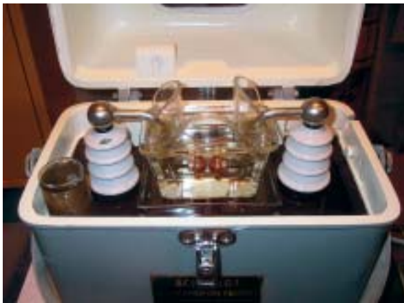
写真2 絶縁油試験装置
