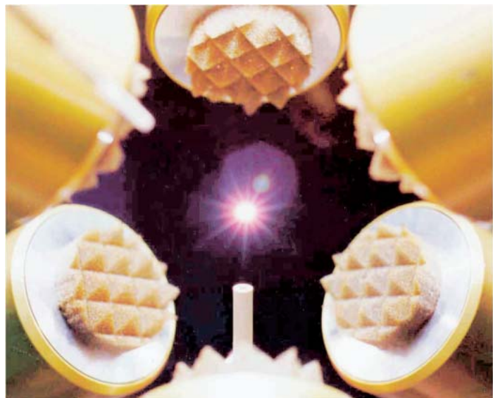
図1 コンテナレス法によって浮上・融解中のかんらん石（フォルステライト、2270 K、直径 \sim 2\text{mm} ）。 \text{CO}_2 ガスレーザーによる加熱を止めるとガラスになる。
