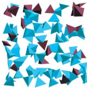
(b) フォルステライト ( \text{Mg}_2\text{SiO}_4 ) ガラスのSi-Oの分布 \text{SiO}_4 四面体は酸素を頂点共有してネットワーク構造を形成
