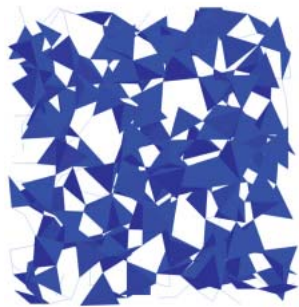
(a) シリカ ( \text{SiO}_2 ) ガラス \text{SiO}_4 四面体は酸素を頂点共有してネットワーク構造を形成
