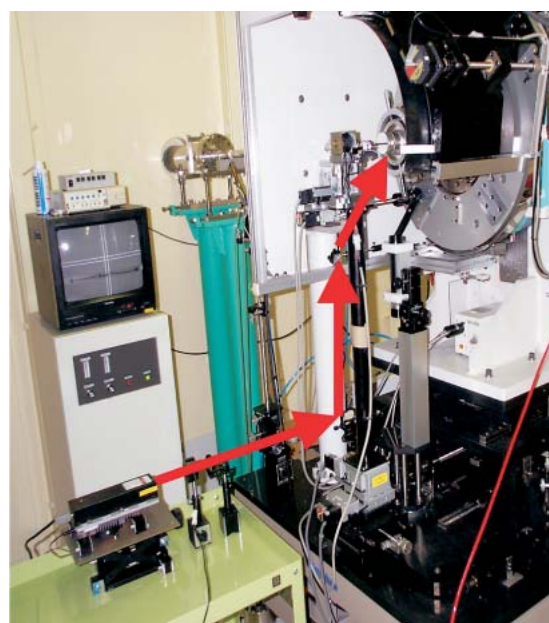
図1 光励起後/光励起下におけるX線粉末回折装置。赤の矢印は励起光の光路。
