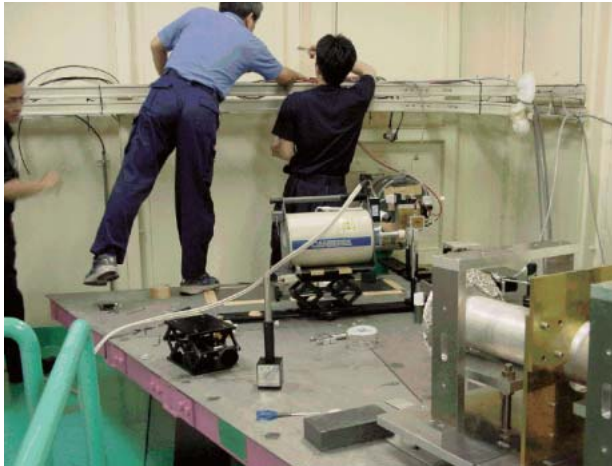
図3 BL08WでSR-XRF分析用の各種機器配置を行っているところ
