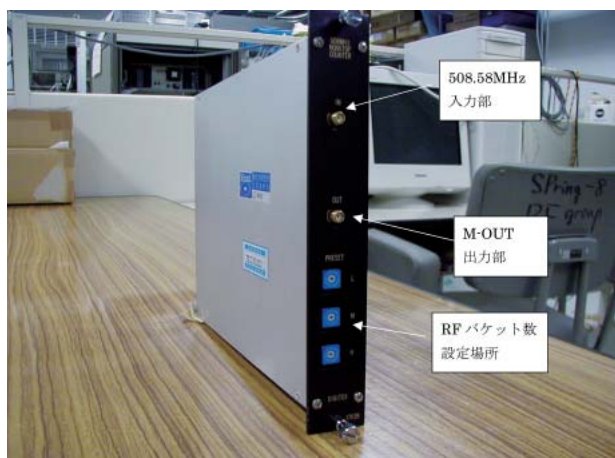
図2 1992年に最初に作ったプロトタイプ16ビットで構成された508MHz SUC
