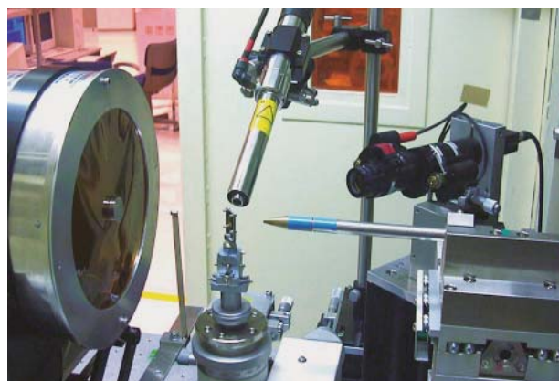
図6 X線 1 分子追跡法の装置配置図 (SPring-8/BL44B2 の場合)。
