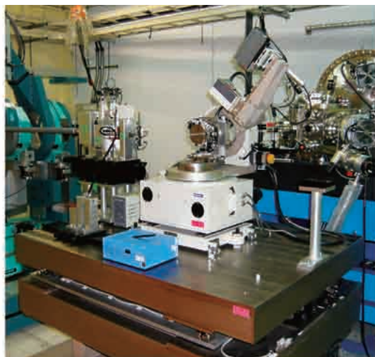
図5 薄膜構造評価専用X線回折計(左)とその実験ハッチ内配置図(右)
