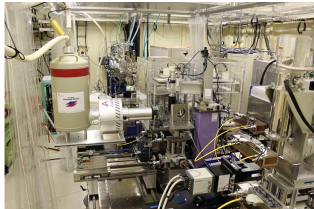
図3 BL36XU実験ハッチ内のXAFS計測装置類
