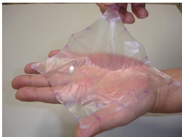
図2 本技術によって得られた高強度ポリエチレン膜
