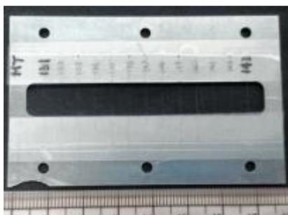
図 1. 測定に使用した試料ホルダ
