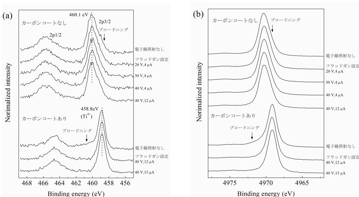
図 1 MLCC 試料から得られた(a)Ti 2p 光電子スペクトルと(b)Ti 1s の光電子スペクトル
