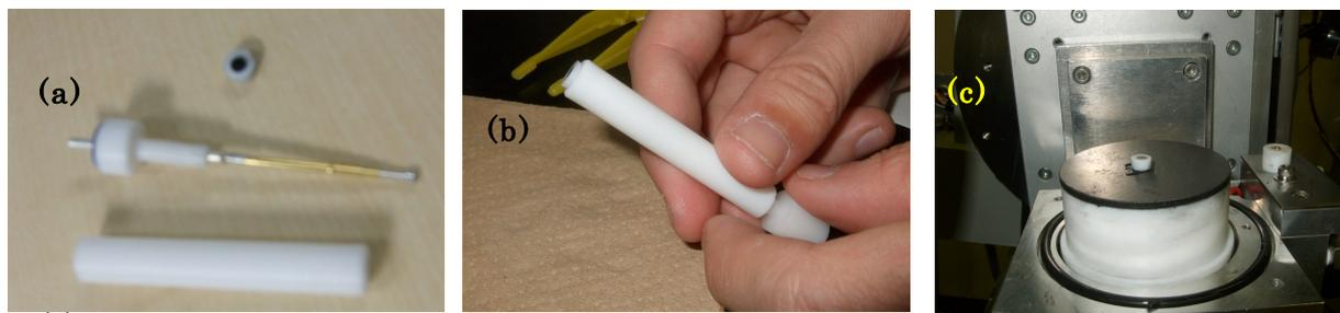
図1 転換電子収量測定に供した作用電極
