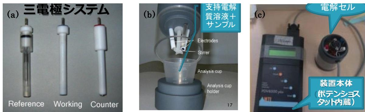
図2 ボルタンメトリ法による測定装置の概要
