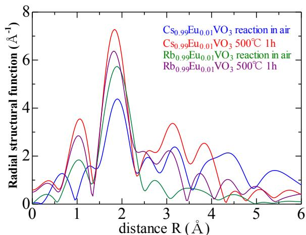
図 3. CsVO<sub>3</sub>:Eu、RbVO<sub>3</sub>:Eu の動径構造関数
