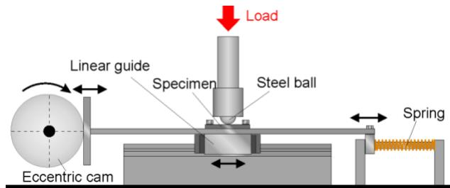
図 2 転動疲労試験機の概要
