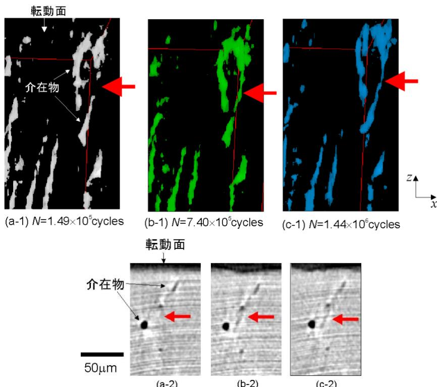
図 5 介在物から発生した転動疲労き裂の変化,
