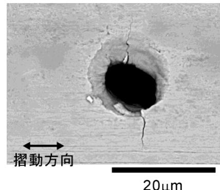
図 4 人工欠陥の SEM 写真
