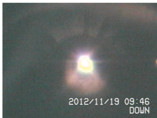
図 2. 104 GPa において片側のアンビル越しに 32 W のファイバーレーザーを照射した際に観察された試料室からの熱輻射光。
