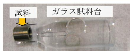
図 2 ガラス試料台と試料容器
