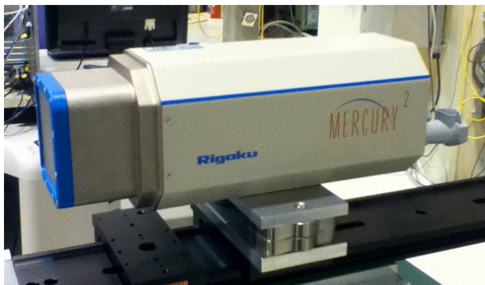
図 4 CCD 検出器の外観図
