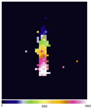
図3 timepix の arrival time mode での計測例. カウント数が低いほどフレーム内で検出された時間が遅いピクセルであることを示している。
